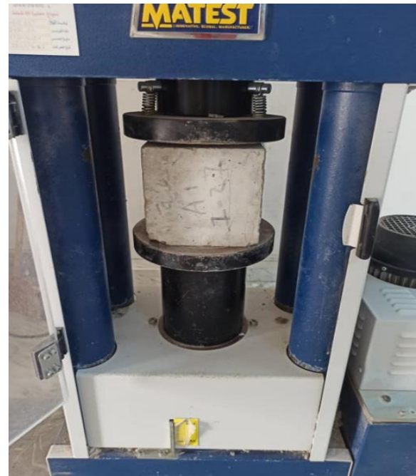
الشكل 6: تسليط الحمل على قوالب الخرسانة
