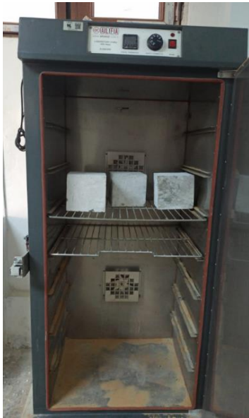
الشكل 7: تجفيف العينات عند درجة حرارة 100 درجة مئوية
